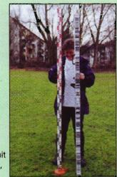
Analoge Nivellierlatte mit Unterlagsplatte (Frosch), Strichcodeplatte
