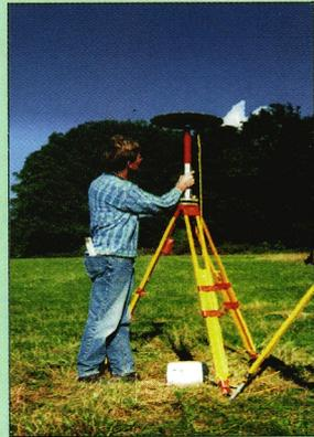
GPS-Empfänger über einem Trigonometrischen Punkt
