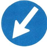
Vwv-StVO: „Es ist wegen der Verwechslungsgefahr mit dem Zeichen ‚Vorgeschriebene Fahrtrichtung‘ streng darauf zu achten, daß die Pfeile genau in einem Winkel von  $45^\circ$  schräg abwärts weisen.“
