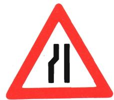
Die Zeichen 120 bis 122 sollen an Arbeitsstellen dort verwendet werden, wo an Straßen mit Gegenverkehr ein Fahrstreifen entfällt oder erheblich eingengt ist. An Richtungsfahrbahnen wird der Wegfall von Fahrstreifen oder eine durch Einengung verschwenkte Verkehrsführung durch Lenkungstafeln (Zeichen 480 bis 496) angezeigt.
