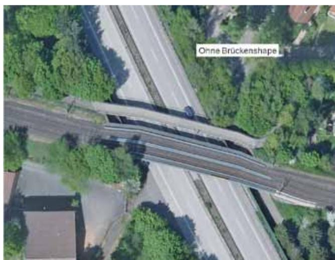
Abb. 11: Brückendarstellung ohne manuelle Korrektur: „Schlingern“
