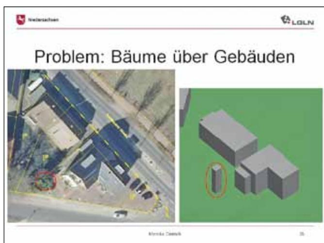
Abb. 28: Fehler bei der automatisierten Modellierung erfordern eine manuelle Nachbearbeitung, z. B. falsche Gebäudehöhe bei Überdeckung durch Bäumen
