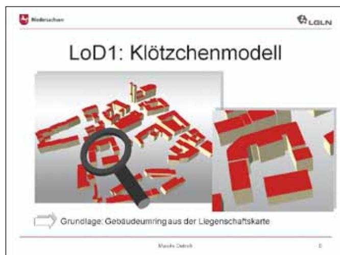
Abb. 23: 3D-Gebäudemodell LoD1, „Klötzchenmodell“, in Niedersachsen im Aufbau, Lagegenauigkeit wie zugrundeliegende Liegenschaftskarte, Höhengenaugigkeit ca. ±5 m
