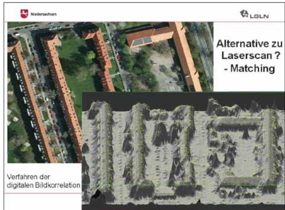
Abb. 20: Vergleich 3D-Datengewinnung mit Laserscanningverfahren oder Matchingverfahren
