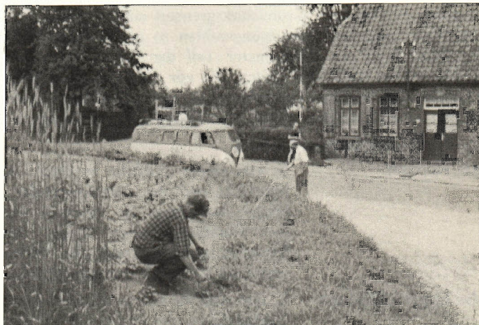
Streckenmessung bei einer Fortführungsvermessung
