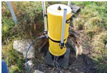
Abb. 18: Absolutschweremessung mit dem A-10 in Wallenhorst
