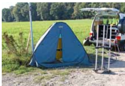
Abb. 19: Absolutgravimeter A-10 mit Windschutz und Hilfsgerät für die Bestimmung des vertikalen Schweregradienten
