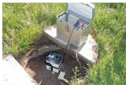
Abb. 22: Relativschweremessung auf einem GGP-Pfeiler
