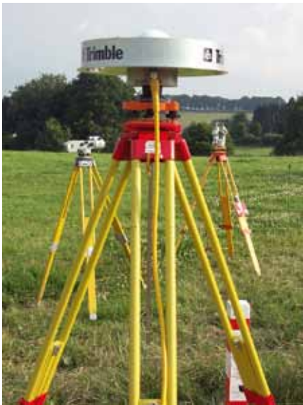
Abb. 7: GNSS-Antenne und klassische Instrumente zur Zentrierungsüberwachung
