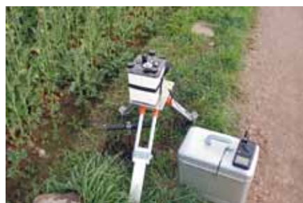
Abb. 21 Relativgravimeter während der Messung über einem unterirdischen GGP
