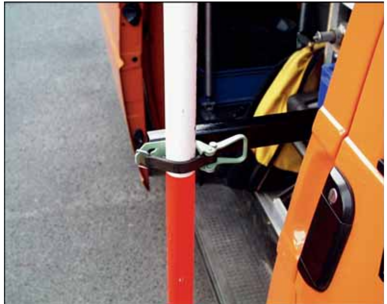
Einfachste Handhabung garantiert ein sogenannter Besenhalter. Zur anderen Seite hin verhindert ein angebrachter Gummistopfen Beschädigungen an der Schiebetür.
