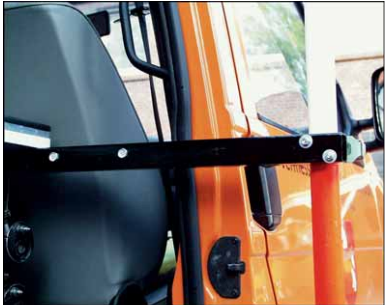
Obere Halterung mit 2 Schrauben befestigt
