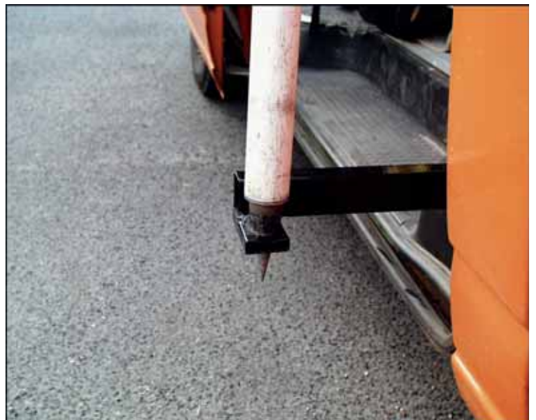
Ein Zentrierloch in der unteren Halterung gewährleistet nicht nur einen stabilen und sicheren Halt, sondern ermöglicht auch eine einfache und schnelle Entnahme des Stabes.
