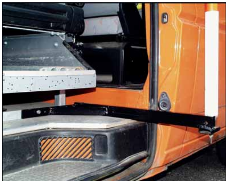
Die Strebe in der unteren Halterung verdeckt in diesem Bild die zweite Schraube
