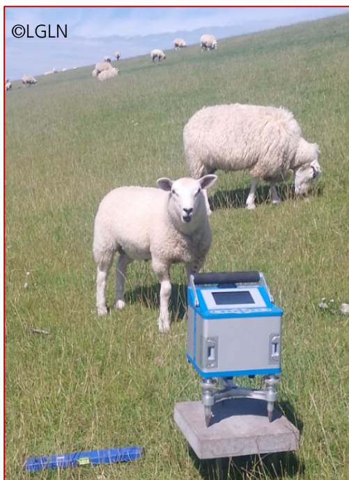
Abbildung 5: Gravimeter während der Schwere-messung an einer Deichanlage
