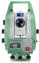
Die reflektorlose Tachymetrie bietet eine Möglichkeit, nicht begehbare Objekte einfach und schnell zu erfassen. Allerdings ist zu beachten, dass Messungen zu glatten Oberflächen nur im rechten Winkel möglich sind und es zu Verfälschungen bei der Aufnahme von Ecken kommen kann.
