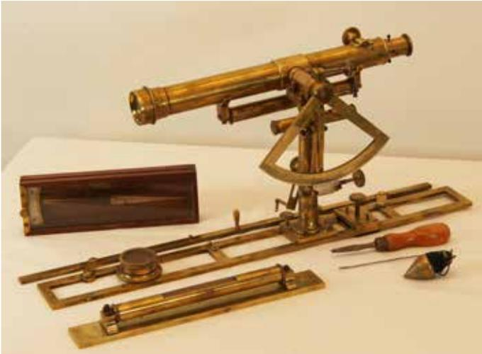
**Abb. 15B:** Kippregel von Hottinger & Cie, Zürich, um 1870, vollständige Geräteausstattung mit Röhrenlibelle zur Horizontierung des Messtischs, Bussole zur Ausrichtung der Kartenvorlage nach Norden, Lot zur Aufstellung des Messtischs über einem bekannten Punkt und Werkzeug für kleinere Reparaturen vor Ort, Exemplar des Museums für Kunst und Kulturgeschichte der Stadt Dortmund, Schausammlung, Abt. 22, Inv.-Nr. 08/130, abgeb. in Stillfried v. 2009, S. 88.
