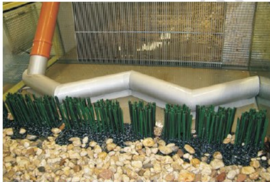
Abb. 4: Aalabstieg über Sammelrohr mit vorgelagertem Bürstenelement. Versuchsanlage in der Versuchsanstalt und Prüfstelle für Umwelttechnik und Wasserbau, Universität Kassel (Quelle [5])
