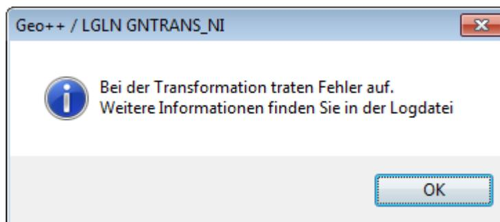
Abbildung 20: Fehlermeldung bei Dateien, deren Datensätze im Hinblick auf die Höhe der Punkte inhomogen sind
