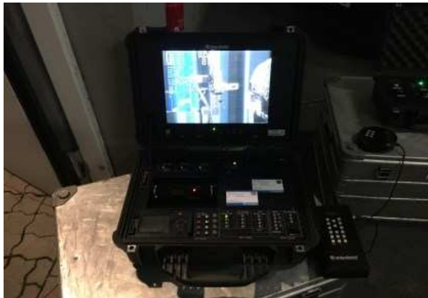
Abb. 8: Videoüberwachung eines Schneidvorganges mit der Wasserstrahlschneidanlage
