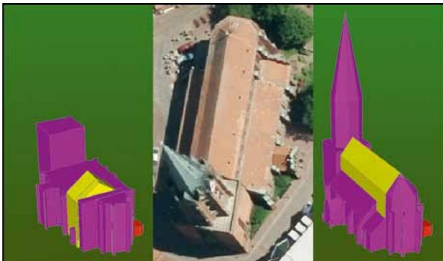
Abb. 5: Nachbearbeitung eines fehlerhaft abgeleiteten Gebäudes
